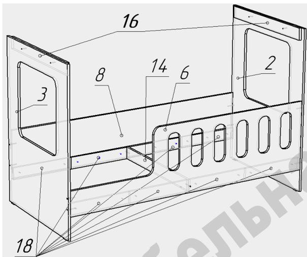
Сборка производится одинаково для правого / левого расположения. Меняются местами детали 2 и 3. Детали 5 и 6 переворачиваются.
